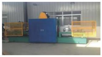
Esta prueba cubre la determinación de la energía requerida por el desatascador de la llantas para penetrar el recorrido por la llantas desinflada indicada por la ruptura, perdida de la presión, repentina salida de la fuerza do botón de salida. La prueba requiere una máquina capaz que lentamente penetra la superficie de la llanta con un desatascador teniendo un hemisférico terminado.
